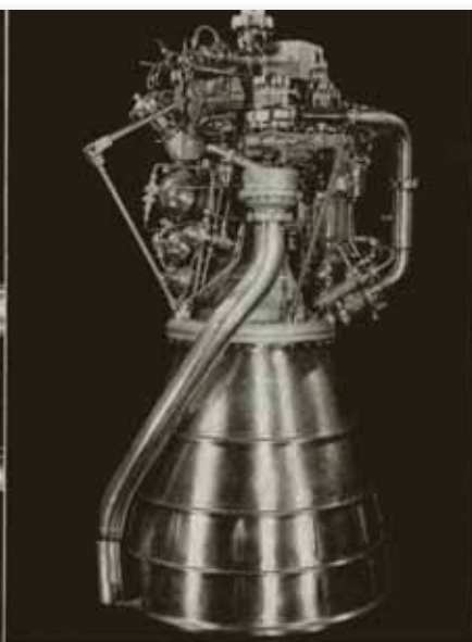
Modèles de turbopompe (à gauche) et de moteur à hydrogène et oxygène liquides HM-7 (au centre) qui propulsera le troisième étage du lanceur « Ariane » et de l'ensemble propulsif du premier étage L 140 (à droite) avec ses quatre moteurs Viking 2 développant une poussée totale au décollage de 240 tonnes environ. Responsable du développement et de la mise au point des ensembles propulsifs des trois étages du lanceur, la Société Européenne de Propulsion fournit les ensembles moteurs, ergols, pressurisation, commande, structures propulsives et servo-moteurs, réalise et exploite les essais intégrés. En outre, la S.E.P. assemble les ensembles propulsifs du premier et du troisième étage.
